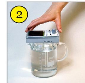
Konzentration und Gefäßgröße am Solyser einstellen, Elektroden ins Wasser eintauchen und Gerät einschalten
