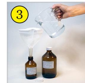
Wenn die 100%-Marke erreicht ist, das fertige Kolloid (gefiltert) in dunkle Glasflaschen abfüllen
